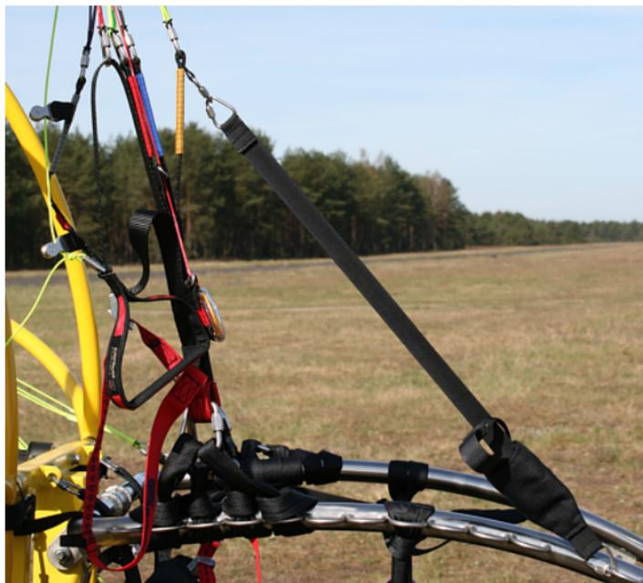
Die Aufziehhilfen verkürzen A-Gurte beim Aufziehen(linkes Foto). Wenn der Gleitschirm über dir steht, dürfen die A-Gurte nicht mehr vorgespannt sein. (Der A-Gurt und die Aufziehhilfen müssen entspannt sein- rechtes Foto)
