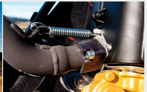
Der Abgasstutzen wurde modifiziert – die ersten Modelle „kleckerten“ ein bisschen und hinterließen Ölflecken.
