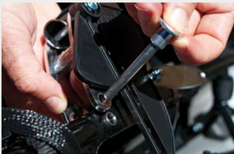
Das Schnappmatiksystem lässt sich mit wenigen Handgriffen demontieren: zwei Pushpins halten den Lenker.
